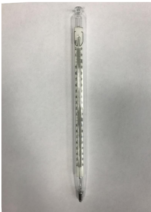
Рисунок 1 - Общий вид термометров максимальных стеклянных СП-83М
