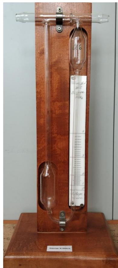
б) Реометр стеклянный лабораторный типа РДС заводской номер 066
