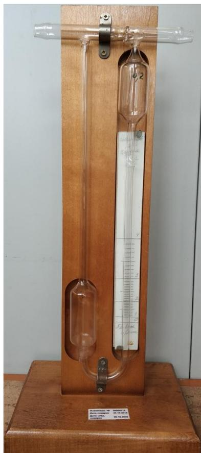
а) Реометр стеклянный лабораторный типа РДС заводской номер 0,2
